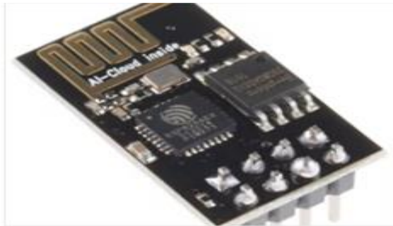
Fig. 5. ESP8266 WIFI module
