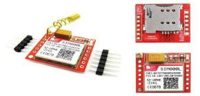
FIG3. GSM module
