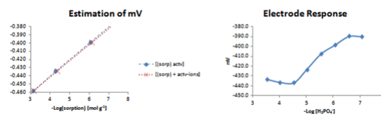
Figure 13: Data fit after applying Nernst equation (d)
