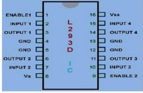
fig 2. Motor Driver IC
