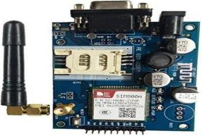
Fig.4.4 SIM800A GSM Module
