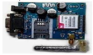
Fig 3 GSM module
